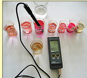
Electrical Conductivity परिक्षण
